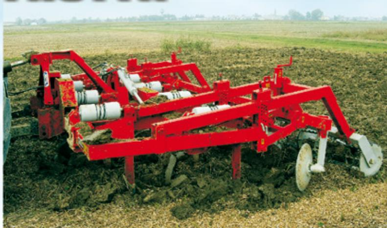
Il coltivatore VULCANO è l'attrezzo ideale per la lavorazione in profondità del terreno fino a 30 - 35 cm. Usato in sostituzione dell'aratura, consente la risalita e il rimescolamento negli strati più superficiali delle sostanze organiche aumentando la fertilità del terreno: impiegato dopo l'aratura permette l'ottimale lavorazione in profondità.
