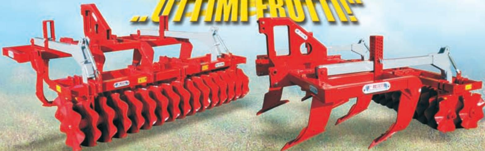
L' AIR DISC, grazie al profilo ricurvo e alla disposizione delle ancore tipo Michel dotate di bullone di rottura, è l' attrezzo ideale per la fessurazione, l' arieggiamento ed il drenaggio del terreno in profondità senza crearne zollosità e inversione degli strati: inoltre, il tipo di solco ottenuto, permette la lenta evaporazione dell' acqua ed agevola il radicamento di nuove colture.
